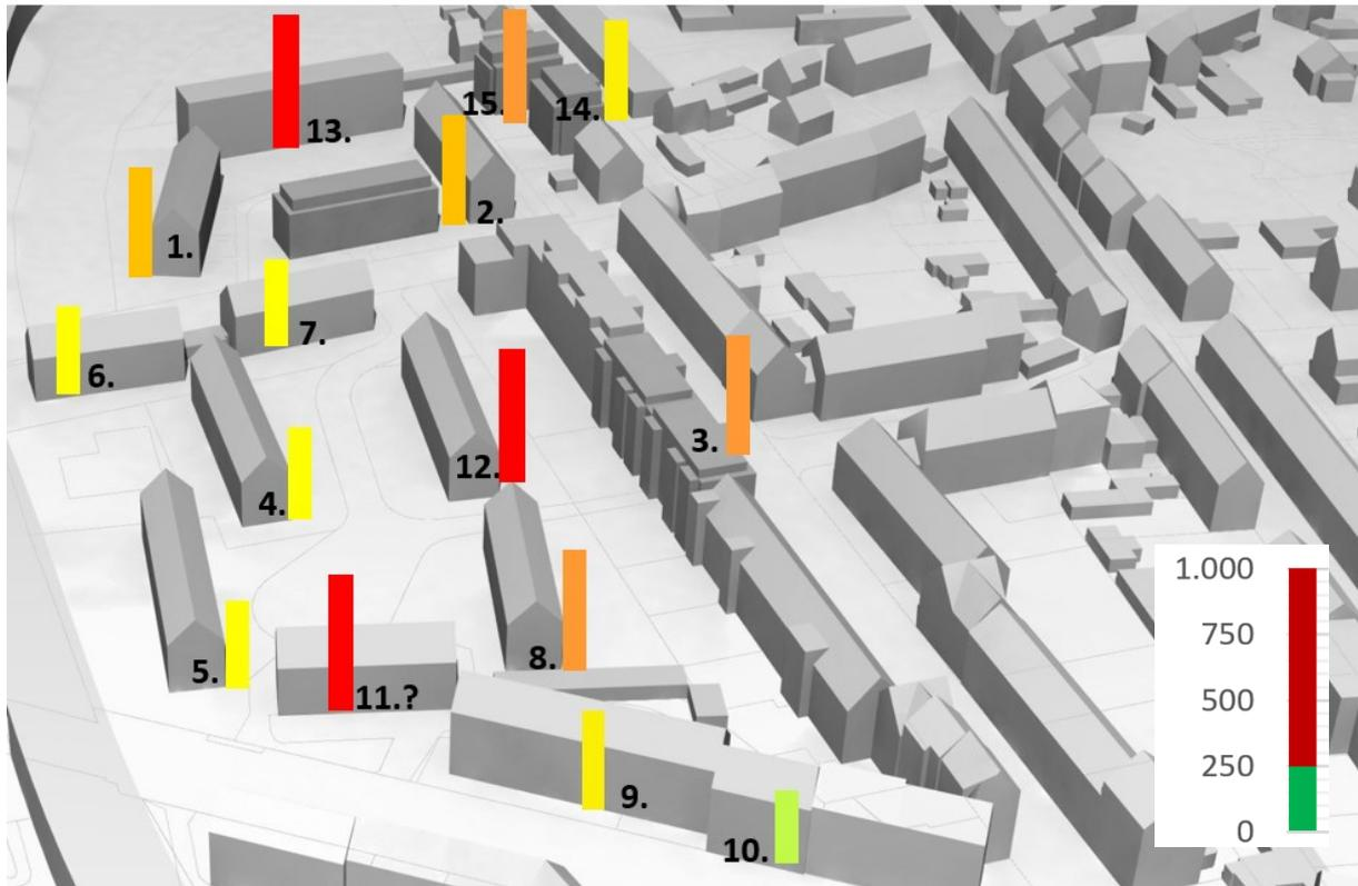
**Bild 5: GWP-Werte aus Modul A1-3** Spezifische CO<sub>2</sub>-Emissionen aus der Herstellung in einem Testbestand nach Berechnung Ruhr-Universität Bochum mit Benchmark (Werte zwischen ca. 480 und 890 kg CO<sub>2</sub>/(m<sup>2</sup>WF).
