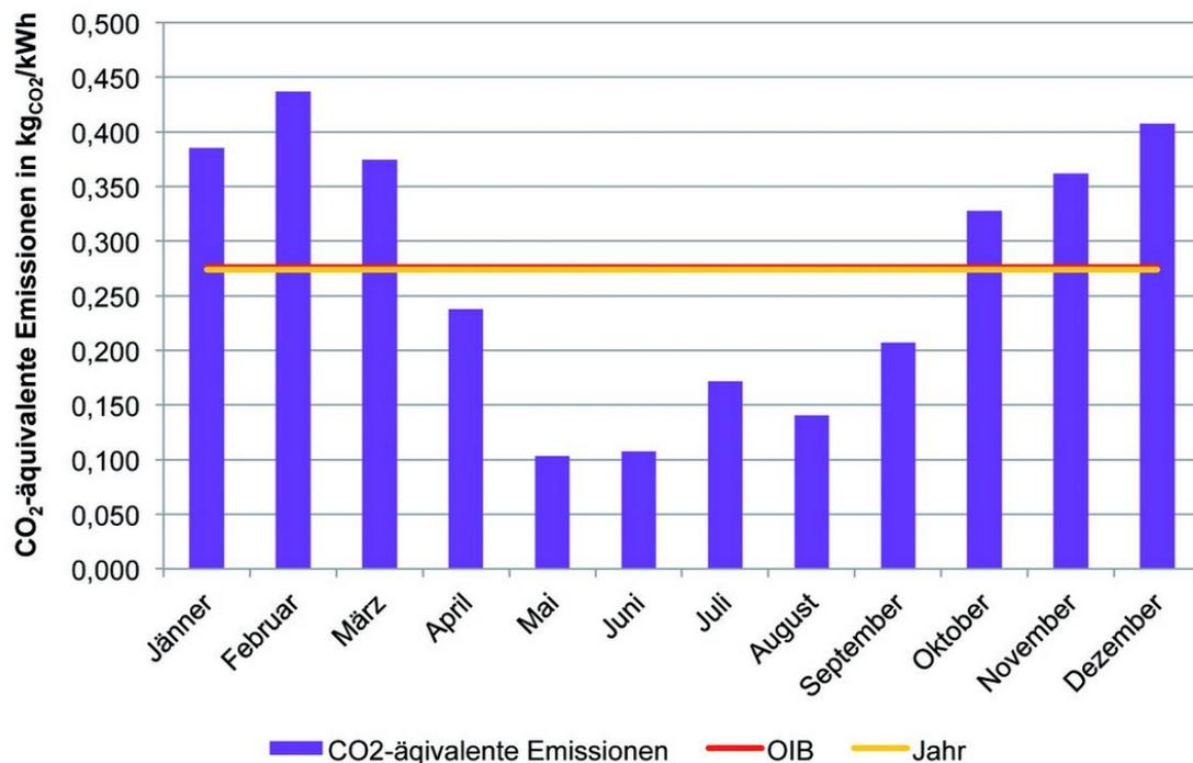
Abb. A 1.3: (Quelle [ibo 2018]). Monatswerte der CO<sub>2</sub>eq-Faktoren des österreichischen Verbraucherstrommix im Mittel der Jahre 2014 und 2015 auf Basis der Monatsdaten Betriebsstatistik gem. E-Control [7], [8]; Konversionsfaktoren CO<sub>2</sub>eq für Kraftwerkstypen nach Stolz [1]
