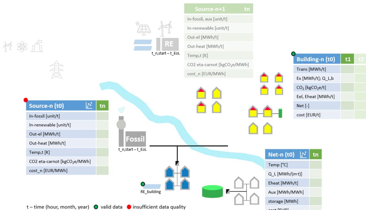
**Bild MSB-02:** sdp Datenmodell-Netze, Skizze mit Kopplung an Methodik gem. Modul Climate-Neutral Buildings. Die Skizze veranschaulicht die Datenlage im Bestand für Gebäude, Netze und Quellen. Im Beispiel liegen nur auf der Gebäude- und Anlagenebene valide Daten vor (Quelle z.B. unzulässig mit 0 gCO<sub>2</sub>e/kWh gem. GEG/AGFW FW 309-1:2020 ermittelt).
