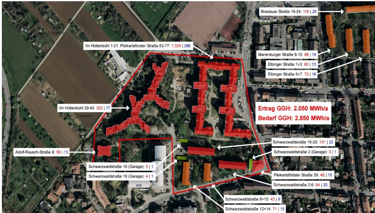
Bild 3: Wärmekataster und Potentialkarten zeigen i.d.R. Jahreswerte für Verbrauch (Bedarf) und Potentiale. Die Karten können genutzt werden z.B. zur Ausweisung und Standortsuche von Wärmespeichern und für Abwägungen der Dachflächenbelegung mit Solarthermie und PV-Anlagen. Über die Jahresbetrachtung ist zumindest eine Monatsbetrachtung notwendig, um Deckungslücken zwischen Angebot und Nachfrage zu identifizieren. Im Bild: Übersicht der solaren Potentiale für Solarthermie mit Identifikation zusammenhängender Gebiete (Quelle: IB-Ortjohann, GGH Solarkarte 2005), rot = solare Vorzugsgebiete.
